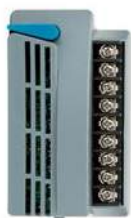
ICM-800 Konventionelles Ausgangsmodul mit 8 Stationen
