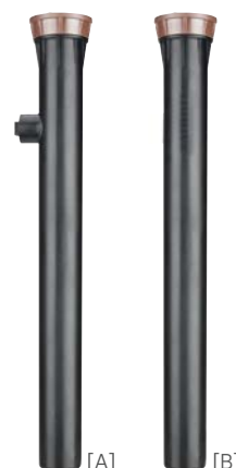
[A] PROS-12-SI-PRS30* [B] PROS-12-PRS30* Altezza da chiuso: 41 cm Altezza pistone: 30 cm Diametro esposto: 5,7 cm Dimensione del filetto d'ingresso: 13 mm (½")
