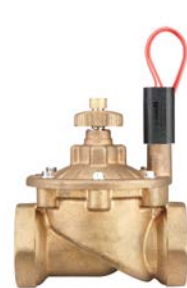
VALVOLA IBV-201G-FS Diametro filetto d'ingresso: 50 mm (2") Altezza: 18 cm Lunghezza: 15 cm Larghezza: 15 cm
