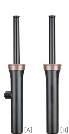
[A] PROS-06-SI-PRS30* [B] PROS-06-PRS30* Altezza da chiuso: 22,5 cm Altezza pistone: 15 cm Diametro esposto: 5,7 cm Dimensione del filetto d'ingresso: 13 mm (½")
